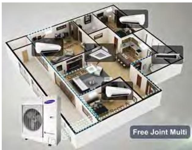
Das Free Joint Multi System ist die beste Lösung für alle, die ein flexibles, effizientes und verlässliches Klimaanlage-system für ihr Wohngebäude suchen. Mit einem einzelnen Aussengerät, das nur wenig Installationsraum beansprucht, können bis zu 5 Innengeräte betrieben werden. Die Nennleistung kann dadurch bis zu 75 % überschritten werden. So ist eine effiziente Kühl- und Heizleistung in verschiedenen Räumen gewährleistet.
